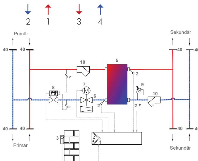
Der Fernwärme- und Heizungsregler RM360 ist eine optimale Integration in das gesamte System der Baureihe aqoClick-S ECO und spielt eine wesentliche Rolle für die flexible Anpassung der Wärmeübergabestation in modularer Hinsicht. Die Stationen haben sowohl oben als auch unten primäre und sekundäre Anschlüsse, was einen vielseitigen Einsatz gewährleistet. Natürlich können auch Regler anderer Hersteller verwendet werden.
